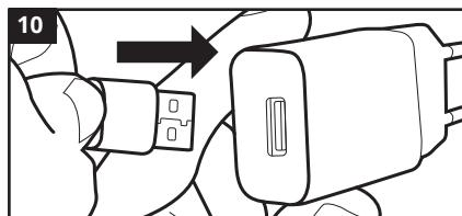
**EN** Attach the power cord to the USB adapter, and plug it into the wall socket. Secure excess power cord with a tie wrap and place it behind the fountain to avoid pet chewing and entanglement. **DE** Verbinden Sie das Netzkabel mit dem USB-Adapter und verbinden Sie das Gerät mit dem Stromnetz.
