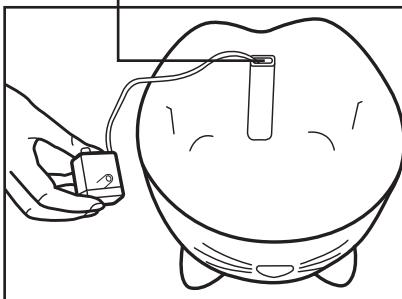
i kabelrenden i vandreservoiret, og træk kablet igennem. Anbring pumpen i siden. **RU** Извлеките устройство из упаковки. Снимите крышку фонтанчика и поддон фильтра. Вставьте USB-кабель в кабельный желоб в резервуаре с водой и протяните через него кабель. Расположите насос сбоку.
